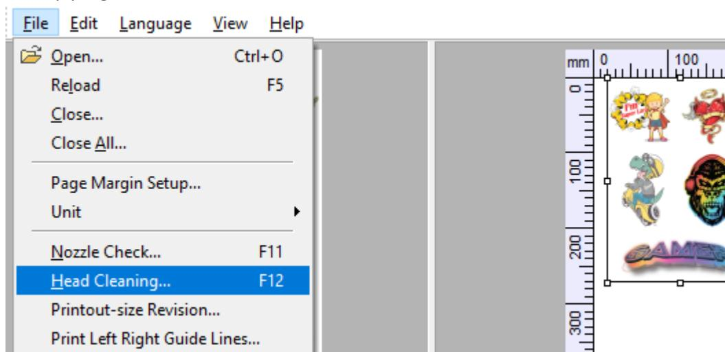
Če se želite prepričati da glava deluje pravilno in so vse barve napolnjene v kartušah potem pritisnite nozzle Check. PAZI preden pritisneš nozzle Check vstavi PET film ker bo tiskalnik tiskal testne okvirčke C,M,Y,K,W barve. Pravilno je, da imete vse črte polne in bo potem tudi tisk odličen.
